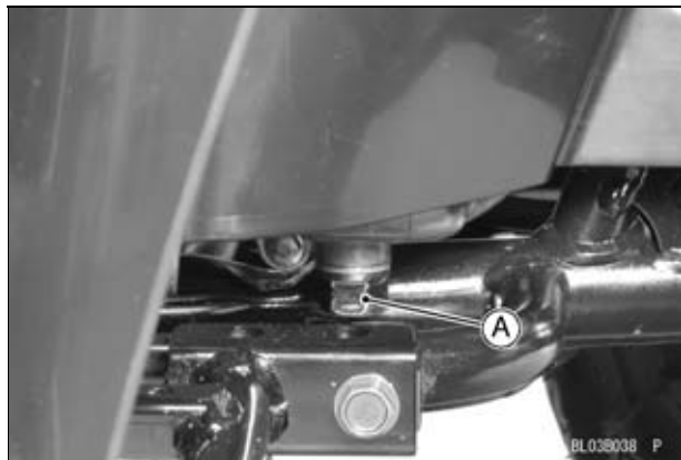
A. Tapón de drenaje
