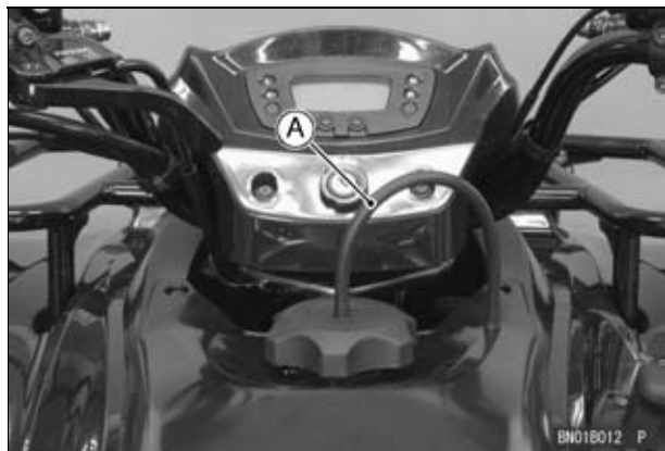
A. Tubo respiradero del depósito de combustible
