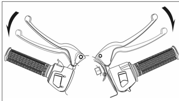
Prueba de los frenos después de lavar el scooter
