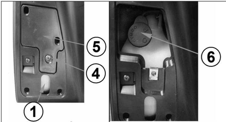
(1) Mirilla | (2) Nivel máximo | (3) Nivel mínimo | (4) Tornillo | (5) Tapa | (6) Tapón vaso de expansión
