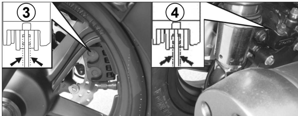
(Izda.) Desgaste pastillas freno delantero | (Dcha.) Desgaste pastillas freno trasero
