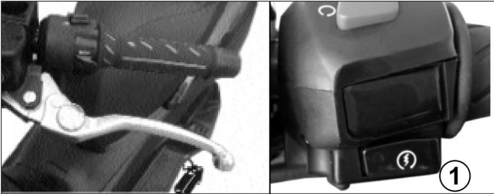
(Izda.) Accionamiento de la maneta de freno | (Dcha.) Botón de arranque (1)
