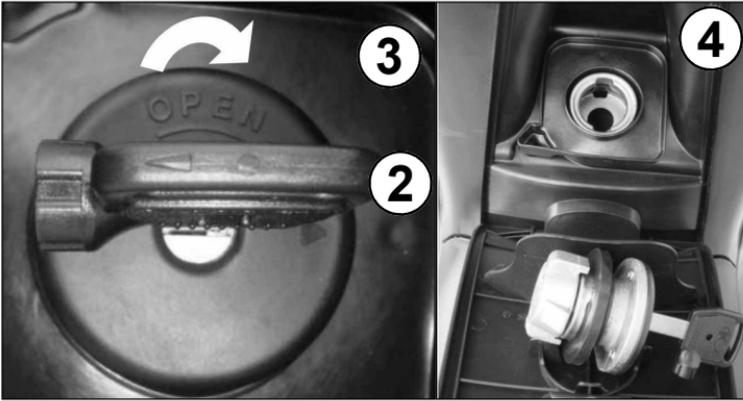
(2) Llave de contacto | (3) Apertura del tapón de gasolina | (4) Tapón de gasolina abierto
