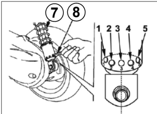
(7) Amortiguador I (8) Llave de ajuste de la precarga
