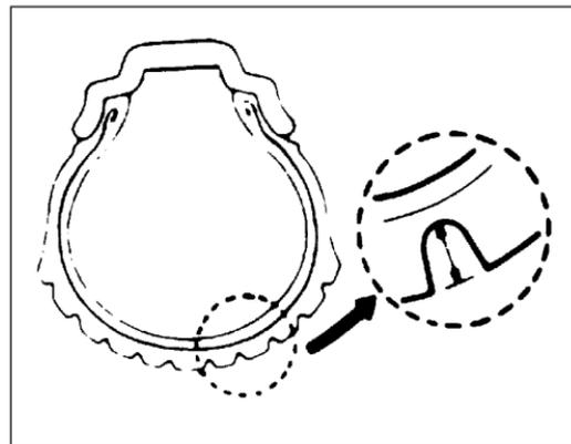
Profundidad de la huella de un neumático
