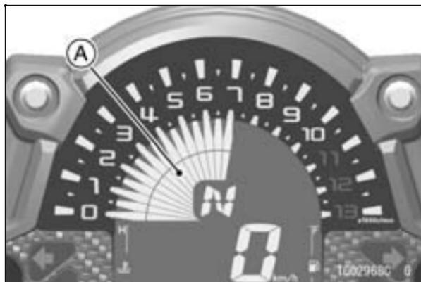
**A. Indicador de cambio de marcha ascendente (indicador del tacómetro)**
