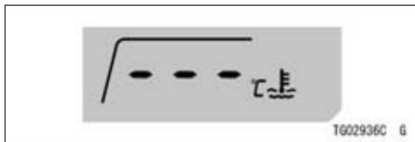
Si la temperatura del refrigerante aumenta por encima de 115 °C y por debajo de 120 °C, el valor de la temperatura actual del refrigerante comenzará a parpadear y al mismo tiempo se encenderán la luz de aviso/indicador del inmovilizador y la luz de aviso de temperatura del refrigerante. Se trata de un aviso al conductor de que la temperatura del refrigerante es elevada.
