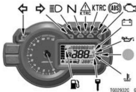
Al poner el interruptor de contacto en la posición de encendido (ON), todos los indicadores se encienden o apagan como se indica en la tabla. Si alguno de los indicadores no funciona de la manera indicada, haga revisar el sistema en un concesionario autorizado Kawasaki.
