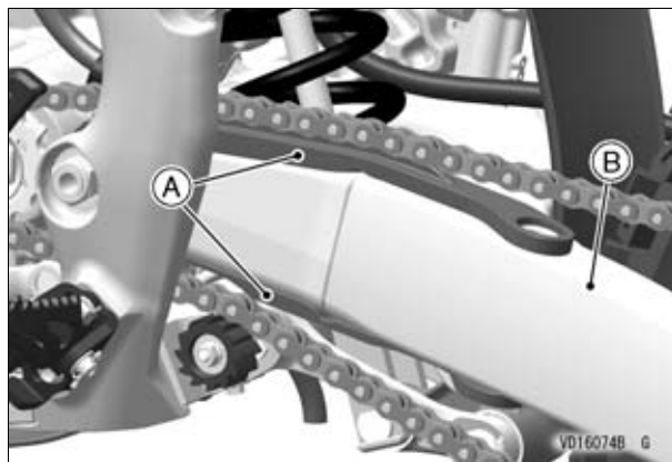
A. Patines superior e inferior la cadena B. Basculante
